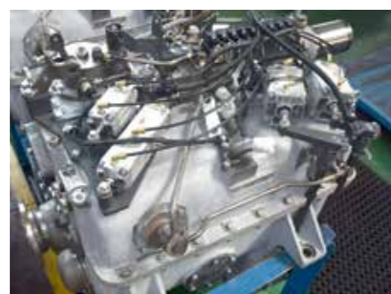
Новая автоматизированная коробка передач «Т5»: шестерни и фрикционы новой конструкции, усиленная гидросистема; новый электронный блок управления коробкой передач и современная прецизионная пневматическая система включения диапазонов позволили автоматизировать работу коробки
